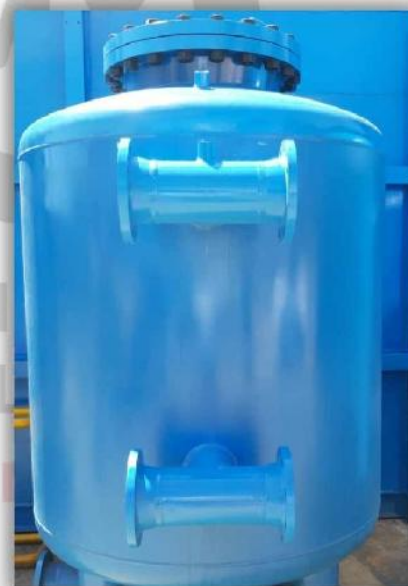
Filtro Arena / Carbón
