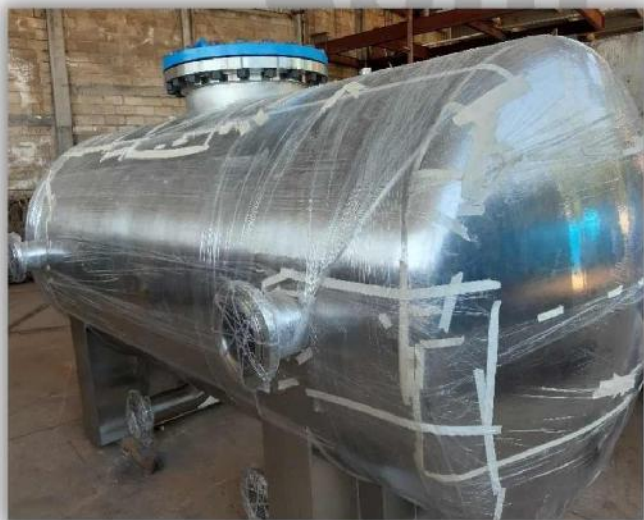
Reactor de coagulación
